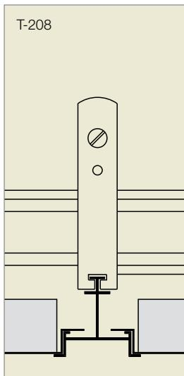
**Sistema de Suspensión.** Las bandejas metálicas desmontables 300 T-208 se instalan sobre perfiles (lay-in) vistos T-208 de extrusión de aluminio. Permite la instalación de bandejas de largo variable entre 1250 y 2000 mm.
